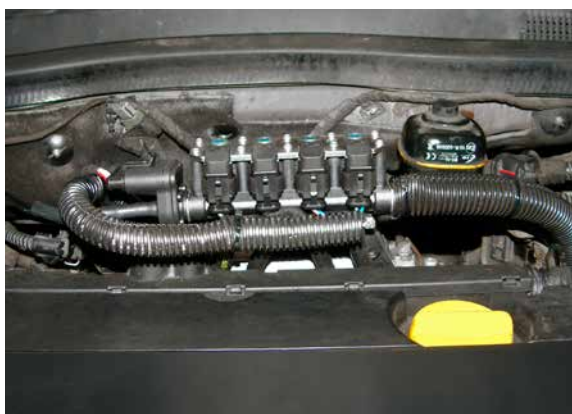
Rys.4 Mocowanie wtryskiwaczy w komorze silnika
