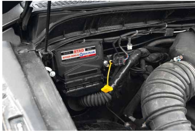
Rys.7 Zalecana pozycja zamontowania sterownika gazu
