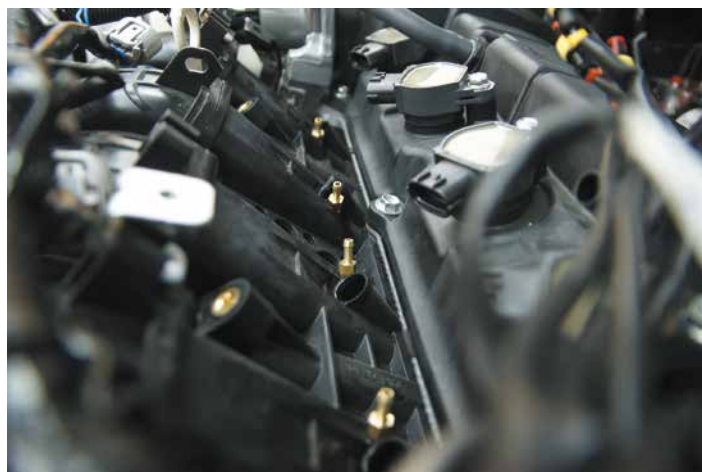
Rys.6 Poprawnie wkręcone dysze w kolektor ssący
