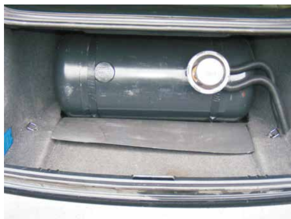
Rys.12 Zbiornik cylindryczny za tylną kanapą
