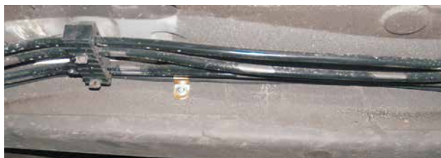
Rys.9 Przewód gazowy zamontowany na „blaszki” montażowe
