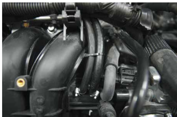
Rys.15 Podciśnienie z kolektora ssącego za przepustnicą
