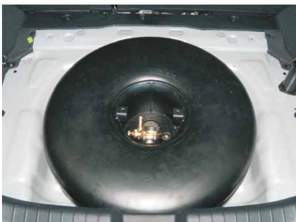
Rys.11 Zbiornik toroidalny w miejscu koła zapasowego
